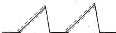
Рис. 8. Регулировка линейности начального участка пилообразного напряжения резистором 3R16.
