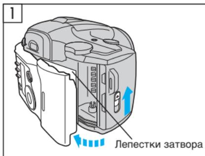
Для открытия задней стороны камеры деблокировку задней стороны сдвинуть вверх.
