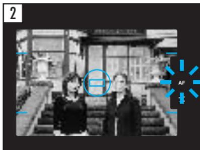
Если звучит звуковой сигнал автоматического фокусирования и вспыхивает индикация автоматического фокусирования видеоскалтера, спусковой механизм далее держать наполовину нажатым и камеру повернуть на желаемую область кадра.
