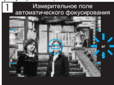
Измерительное поле автоматического фокусирования направить на мотив и наполовину нажать на спусковой механизм. Для съемки спусковой механизм нажать до конца вниз. При этом экспозиция также одновременно запоминается (запоминающее устройство).
