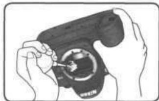
**3** Выключите фотокамеру. Зеркало вернется в нижнее положение и шторки затвора закроются. Установите на фотокамеру объектив или оденьте крышку на байонет.
