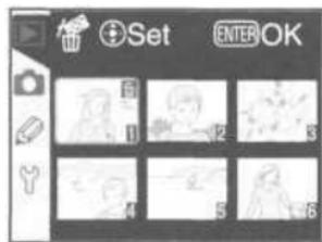
3 Повторяя шаги 1 и 2, выберите другие снимки. Чтобы снять со снимка отметку выберите его и нажмите центральную кнопку мультиселектора. Для выхода без удаления снимков нажмите кнопку **MENU**.
