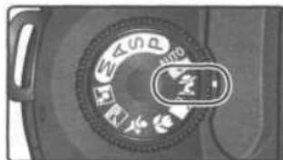
Цифровые сюжетные программы доступны только в случае, если на фотокамеру установлен объектив со встроенным микропроцессором. Если установлен объектив без встроенного микропроцессора, то спуск затвора блокируется. О настройках, доступных в режимах цифровых сюжетных программ, Вы можете прочитать в разделе "Настройки фотокамеры" (📖 182).
