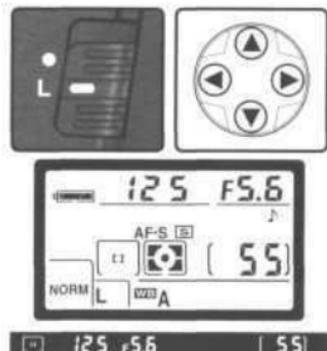
После выбора зоны фокусировки, переключатель блокировки зоны фокусировки можно сдвинуть в положение L (заблокировано), чтобы предотвратить случайное изменение зоны фокусировки при нажатии мультиселектора.
