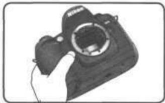
**5** Выключите фотокамеру. Зеркало опустится в прежнее положение, а затвор - закроется. Поставьте объектив обратно на фотокамеру и отключите от нее сетевой блок питания EH-5.
