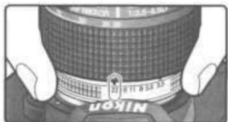
Если Вы не сделаете этого при установке объектива со встроенным процессором, то при включении фотокамеры на контрольном дисплее и в видоискателе будет мигать значение диафрагмы **FE E**. Фотографии нельзя будет сделать до тех пор, пока Вы не выключите фотокамеру и не заблокируете диафрагму объектива на максимальном f/числе.
