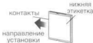
Гнездо карточки памяти сделано с небольшим наклоном (см. рисунок справа). При установке карточки памяти вставляйте ее также с небольшим наклоном.
