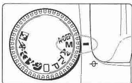
**1** Поверните диск установки режимов в положение <M>.
