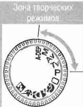
В зону творческих режимов входят режимы, позволяющие выбирать выдержку затвора или величину диафрагмы и самостоятельно изменять величину экспозиции, обеспечивая более гибкую настройку камеры для различных стилей съемки. В этой главе рассматривается эффективное применение каждой из этих функций.
