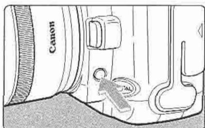
Нажав кнопку предварительного просмотра глубины резкости, можно закрыть диафрагму до текущего установленного значения и проверить глубину резкости в видоискателе.
