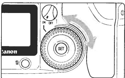
Во время съемки поворачивайте диск <○>, смотря в видоискатель или на ЖК-дисплей.
