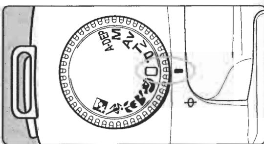
**Диск управления поверните в положение <□> (полностью автоматический режим).**
