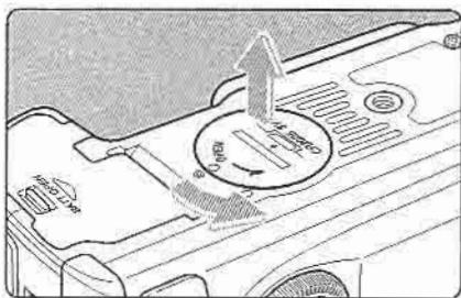
**2 Откройте крышку отсека элемента питания календаря, повернув ее на 45° против часовой стрелки, как показано стрелкой на рисунке.**
