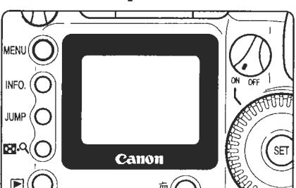
ЖК-монитор на задней панели камеры можно использовать для просмотра и выбора изображений, а также для выбора и установки функций меню.
