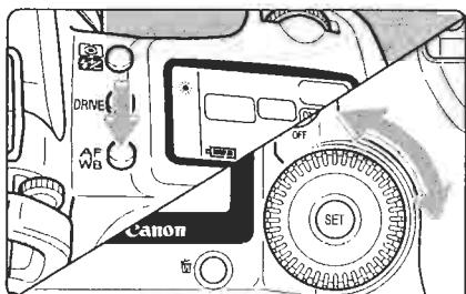
При нажатии кнопки ее действие сохраняется до истечения выдержки времени (06). В течение этого времени можно поворачивать диск <○> и просматривать установки на ЖК-дисплее.
