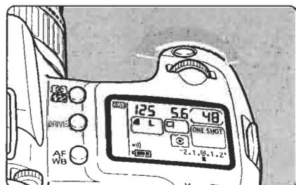
Поворачивайте диск <
